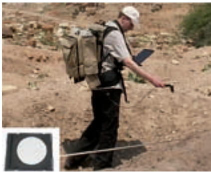
Fig. 6. De veldspectrometer; linksonder is het spectralon afgebeeld.
